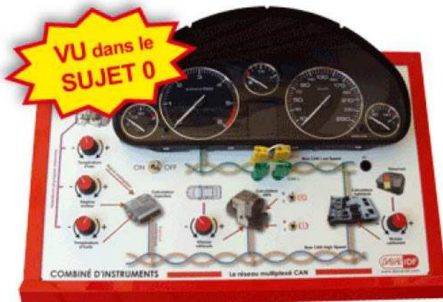
Этот дидактический макет предлагает изучение соединения панели приборов автомобиля по мультиплексной шине CAN.
