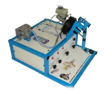
Обучающий макет обеспечивает всестороннее изучение тормозного привода с усилителем (сервотормоза) и главного цилиндра. Особенно подходит для изучения функционального и структурного анализа систем, механики, технологии и практических работ.
