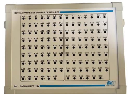
Les faisceaux de dérivations seront raccordés au coffret à l'aide de connecteurs industriels mâle(s)/femelle(s) présents sur les côtés gauche et droit. Ces connecteurs sont conçus pour être manipulés régulièrement par opposition aux connecteurs constructeurs.
