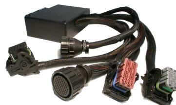
Après connexion sur le calculateur, via la boîte à bornes, le faisceau dérivateur permet la mesure par dérivation des signaux électriques : Euro 6, ABS, habitacle... Puisque chaque type de voiture a des connecteurs différents, One-Too développe des faisceaux dérivateurs sur mesure, à partir des méthodes de réparation du constructeur automobile.
