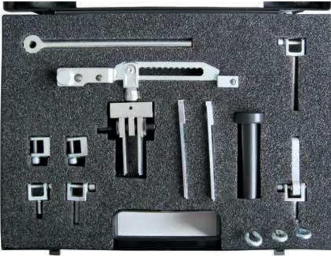
Griff, Rasterschiene, Universal-Druckstück, Einhängeraster, Einhängegabeln (Außengewinde: M7x60, M6, M7, M8; Innengewinde: M6, M8), Einhängehaken (M6, M7, M8), Schlagdorn, Druckarme (80 mm) Werkzeug wird komplett im Koffer geliefert.
