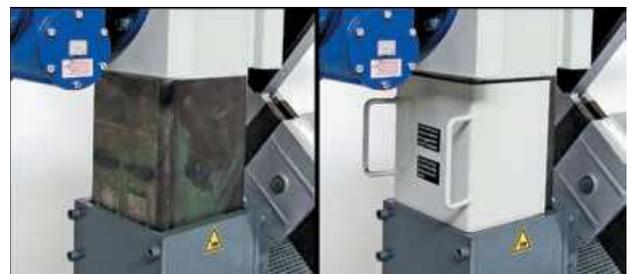
Abbildung mit Sicherungsblech / Picture with safety plate
