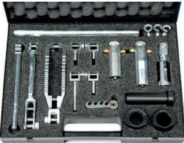
Schlagbolzen, Hebelgriff, Verlängerung, Rastendrucker für Druckstück, Druckgabel für Montagepatronen, Druckstück für Rastendrucker, Montagepatronen mit Längen von 83 mm (Benziner) und 102 mm (Diesel), Führungsbuchsen mit Längen von 33,5 mm (Benziner) und 53 mm (Diesel), verschiedene Haltegabeln (M6x15, M7x25, M7x60 mit 30er Gewinde, M8x20), Gewindehaken (M6x23, M7x24, M8x20), Raster mit Gelenklager. Werkzeug wird komplett im Koffer geliefert
