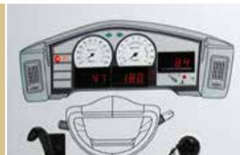
Lorsque le niveau de formation l'exige, le panneau d'acquisition intégré permet de réaliser des acquisitions des paramètres à l'aide des outils de mesures informatisés par exemple.
