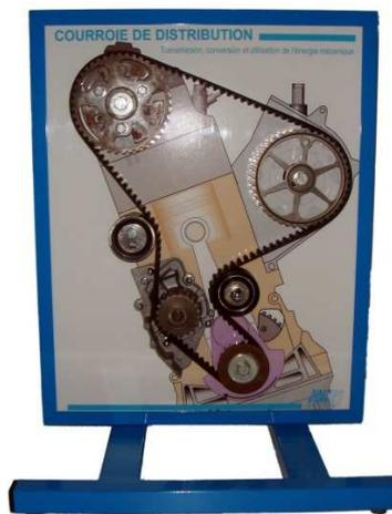
Ремень привода ГРМ является связующим звеном между коленчатым валом и распределительным валом через водяной и топливный насосы. Он описывает заданный ход, определенный расположением шестеренок и колес. Повреждение системы передачи ремня двигателя приведет к остановке транспортного средства, что также может вызвать частичное разрушение двигателя и, следовательно, значительных материальных затрат.
