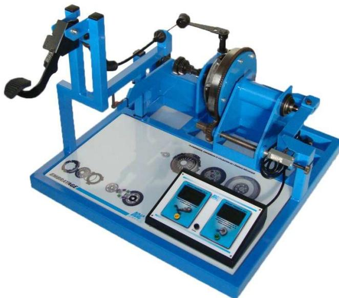
Система сцепления - устройство временного соединения, позволяющее осуществить изменение скоростей коробки передач. Сцепление предназначено для кратковременного отсоединения двигателя от трансмиссии и плавного их соединения при переключении передач, а также предохранения элементов трансмиссии от перегрузок и гашения колебаний.
