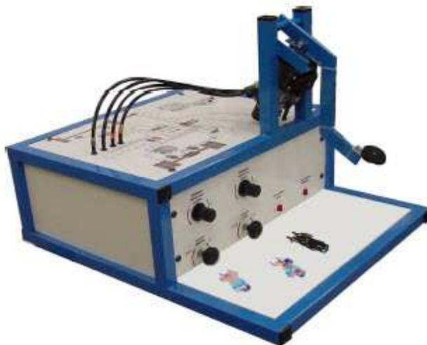
Данный макет предназначен для изучения тормозного крана грузовика (пневматическое торможение) тип EBS. Подходит для изучения функционального и структурного анализа систем, механики, технологии и практических работ.
